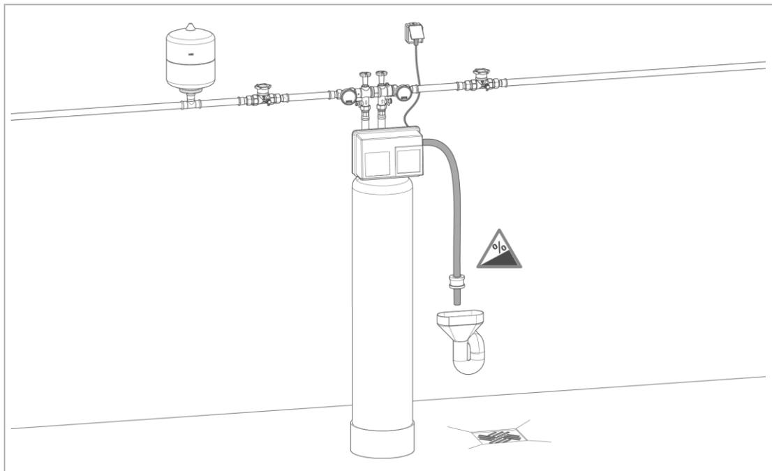
1. Fixieren Sie den Spülwasserschlauch mit der Schelle am Anschluss des Steuerventils.
