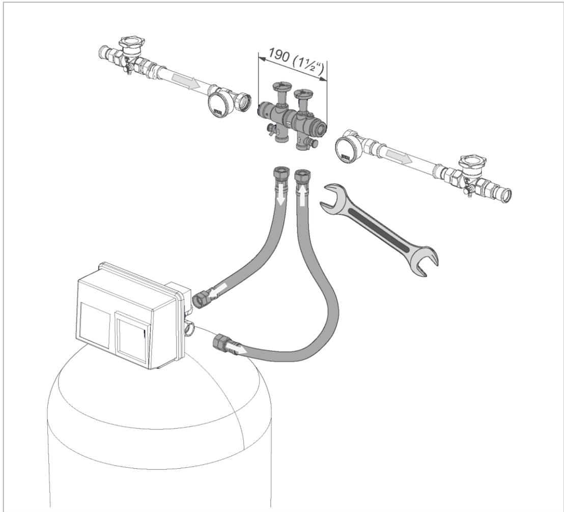
1. Installieren Sie die Anschlussverschraubung in die Rohrleitung.
