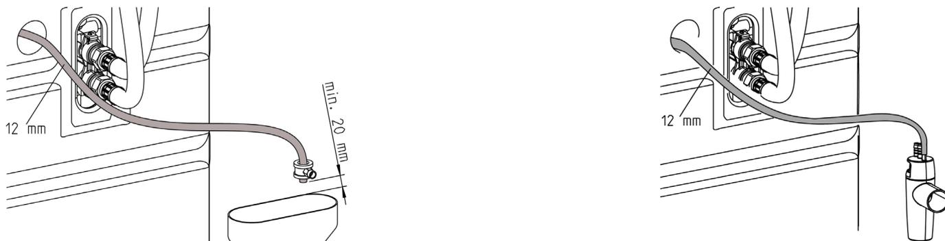
Fig. D-3 : Raccordement à la canalisation du flexible d'eau de rinçage avec et sans raccord à la canalisation DN 50 selon DIN EN 1717 (réf. 188 875)
